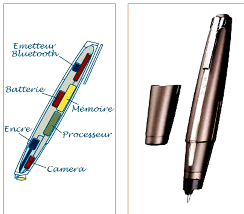
Illustration 7 : Schéma et photo d'un stylo numérique
